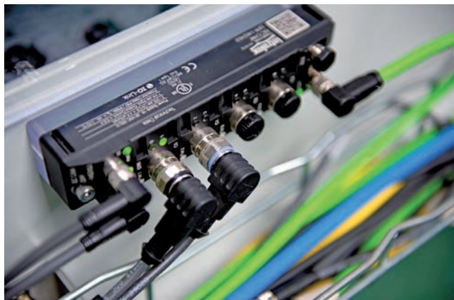
ISC CAM: blokové moduly s logikou Intralox umožňujú použitie dopravníkového systému bez zložitých skríň.
