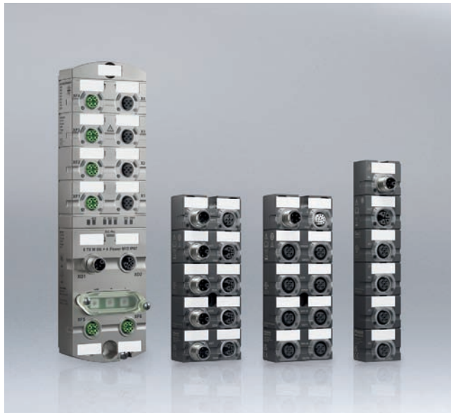
Inštalčné riešenia Vision od Murrelektronik (zľava doprava): Xelity Hybrid Switch preberá dátovú komunikáciu a napájanie prúdom, Injection Box je štvornásobný 24 V napätový a signálový napájač, Master Breakout Box rozvádza napätie a signály a NEC Class 2 Splitter je čisto napätový a signálový rozbočovač.
