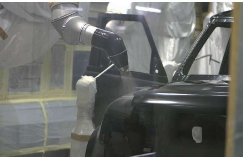
Robotická aplikácia laku vysokootáčkovým aplikátorom
