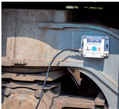
Obr. 1 IoT snímač vibrácií na konštrukcii podvozku vlaku
