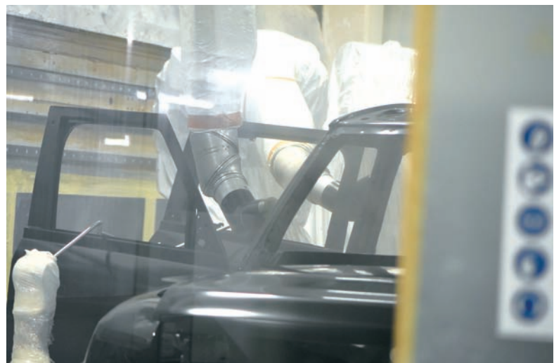
Robotická aplikácia laku pri otvorených dverách karosérie
