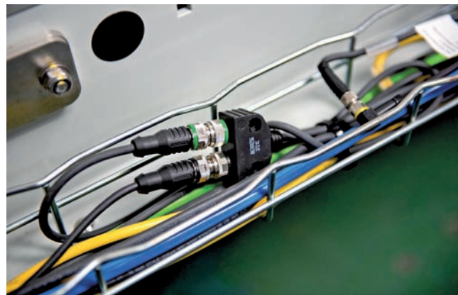
Rýchlu a bezproblémovú kabeláž sľubujú konektory M12 s farebne odlišenými krúžkami na pripojenie poka-yoke.
