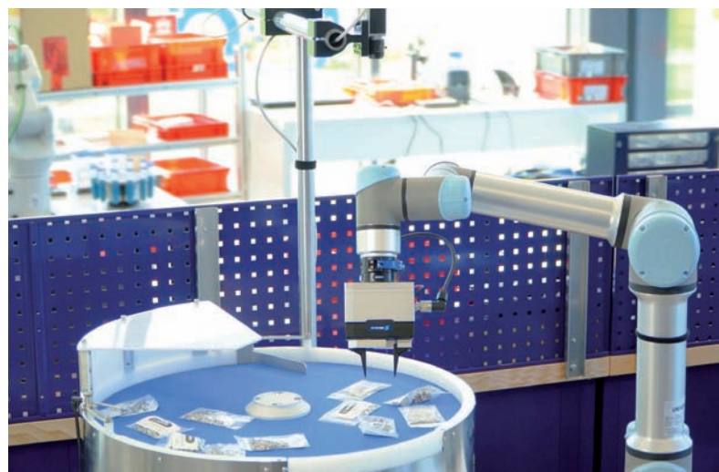
2D súprava na uchopenie odbremeni ľudských pracovníkov od monotónnych úloh, ako je triedenie a presné umiestňovanie predmetov.
