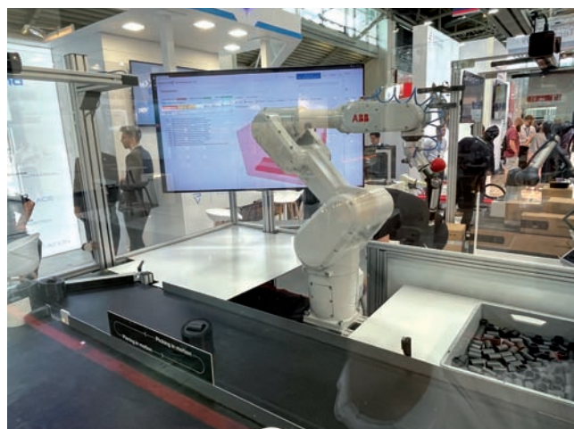
Manipulácia s dielcami na pohybujúcom sa dopravníkovom páse alebo dynamické zakladanie dielcov naznačujú možnosti produkcie bez nutnosti zastavovania. Vďaka riešeniam od Photoeno je to už realita.
