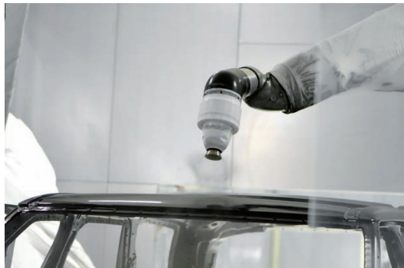
Robotická aplikácia farby na strechu karosérie s kontrastnou strechou
